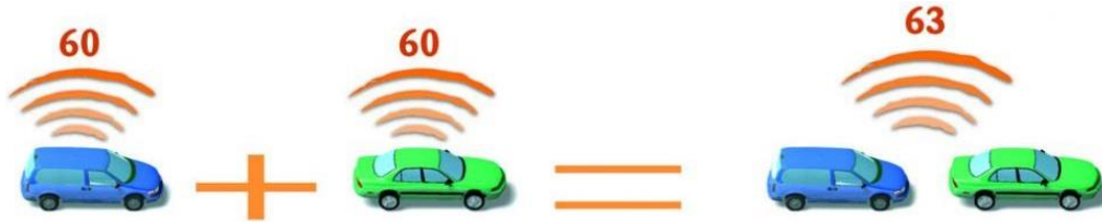
Figure 3 – Addition de 2 sources de même intensité
