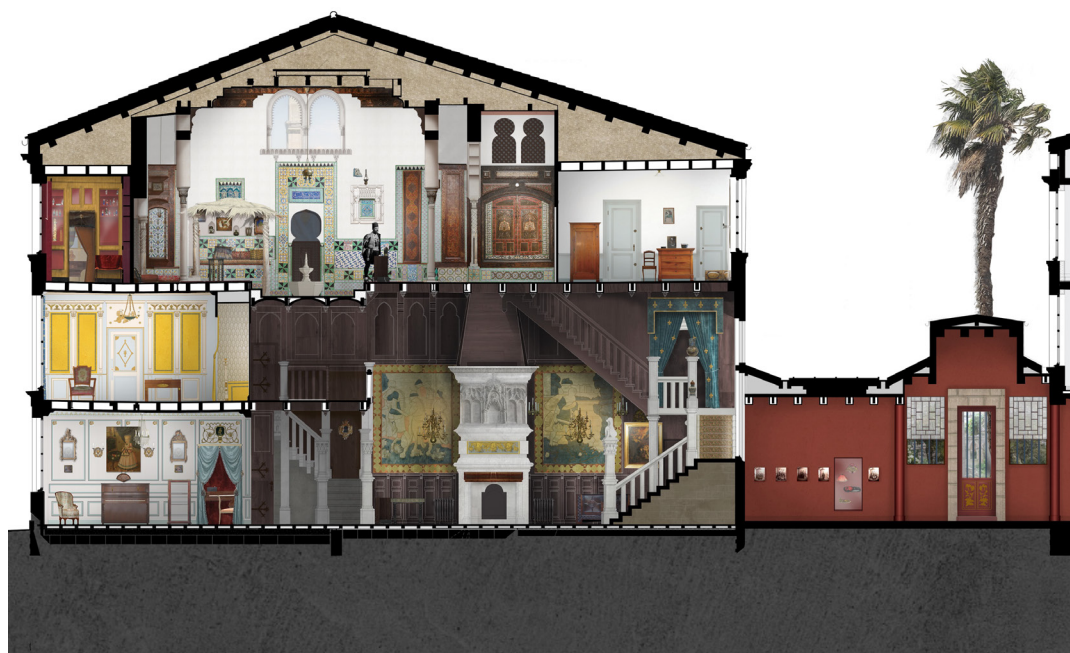
Suppression de planchers, surélévation, extension sur cour (© Sunmetron)
