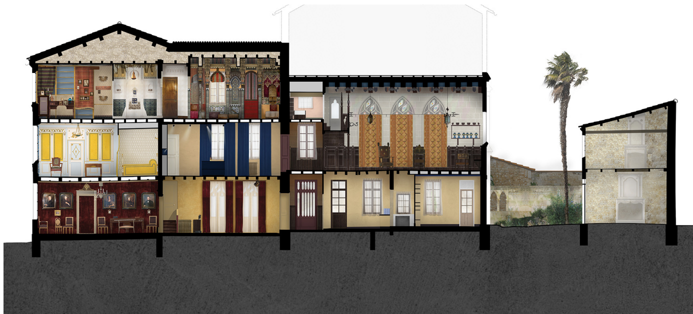
Suppression de planchers, surélévation, extension sur cour (© Sunmetron)
