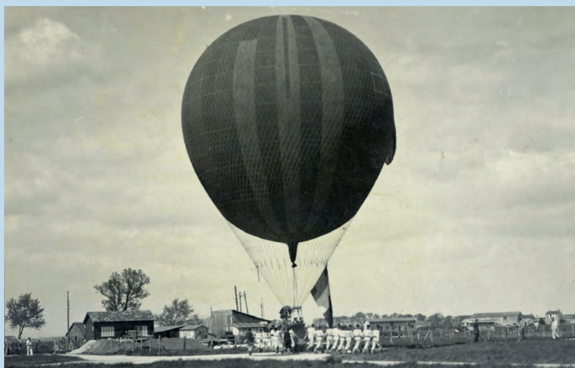
Un ballon libre : sphérique, gonflé d'hydrogène et relié à une nacelle, il est utilisé en école. Carte postale fonds numérique Allary, Archives municipales de Rochefort
