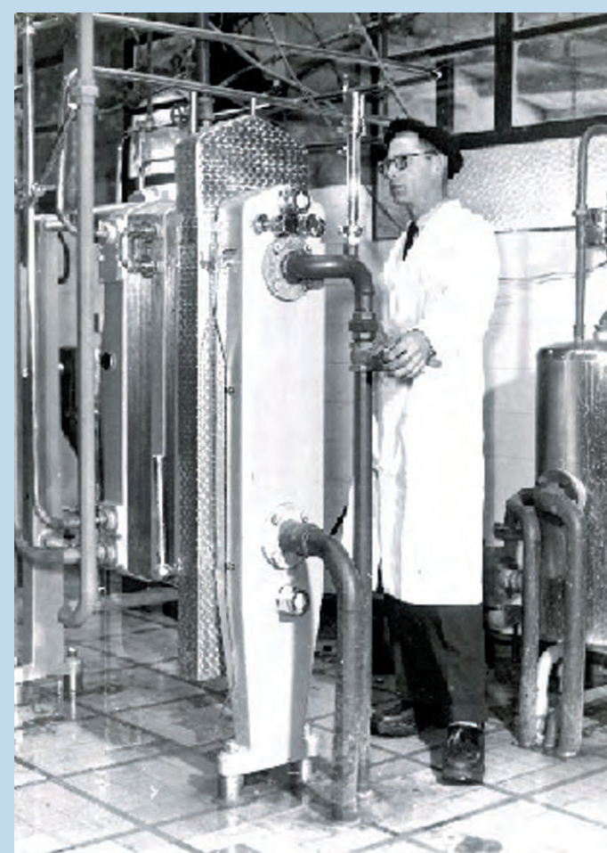
Henri Renaud face à la machine «Stassano» en phase de stérilisation.
