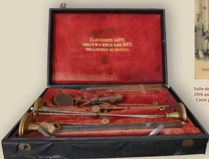
Compas localisateur de Hirtz qui permettait de repérer les projectiles à l'intérieur du corps des soldats, en liaison avec un appareil de radiographie. Mis au point en 1907, par Hirtz, médecin militaire du Val-de-Grâce, il a beaucoup servi pendant la guerre. Musée national de la Marine/École de médecine navale, Rochefort
